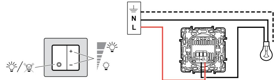
■ Схема подключения с возможностью управления внешними кнопками (Кат. № 6 72X1 4) без подсветки
