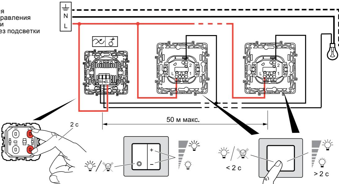
■ Схема подключения с возможностью управления от внешнего переключателя (Кат. № 6 72X 11) без подсветки
