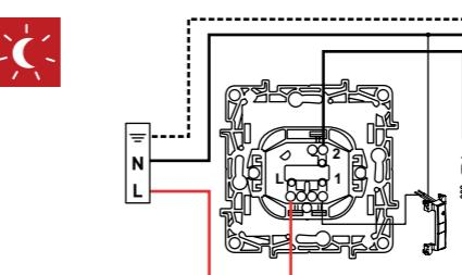
Указанный способ подключения предотвращает мерцание энергосберегающих ламп в выключенном состоянии.
